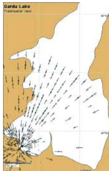
Un esempio della copertura con le misure della corrente superficiale ottenute da una postazione radar ad alta frequenza situata a Desenzano (BS). I vettori rappresentano la componente radiale della corrente superficiale. La lunghezza del vettore è proporzionale all'intensità della corrente.
